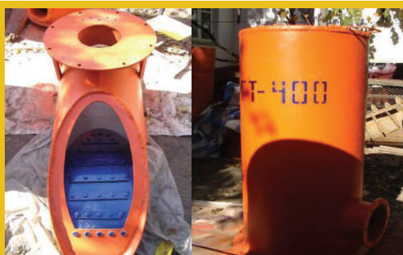
Гидротаран ГТ-400 в разобранном виде. Изготовитель ООО «Гидропульс»
