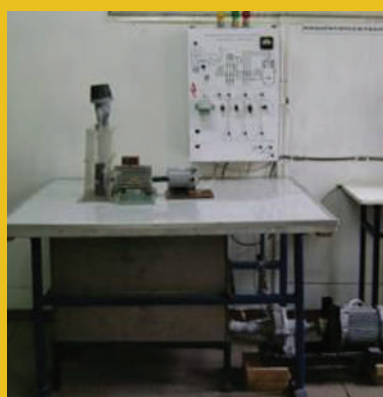
Макетный стенд микроГЭС с асинхронным генератором и системой обратного водоснабжения
