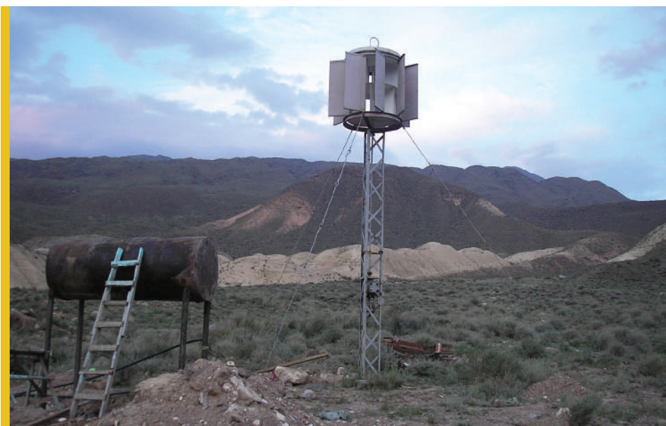
Опытный образец роторного ветродвигателя. Боомское ущелье
