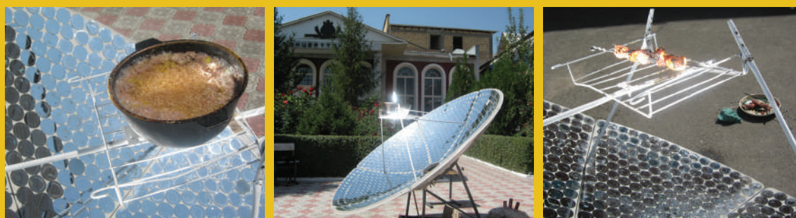
Солнечные параболические печи для приготовления пищи
