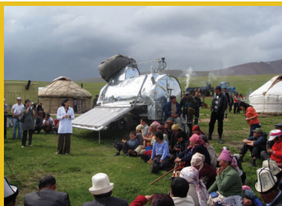
Мобильная биогазовая установка БЭМ-5 , комбинированная с системой солнечного подогрева реактора. с. Дон Алыш, Нарынская область, КХ «Байтерек»
