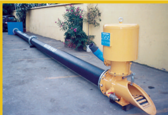
Гидротаран ГТ-300 в сборе с пластмассовой ударной трубой. Изготовитель завод «Кроммаш» (Турция)
