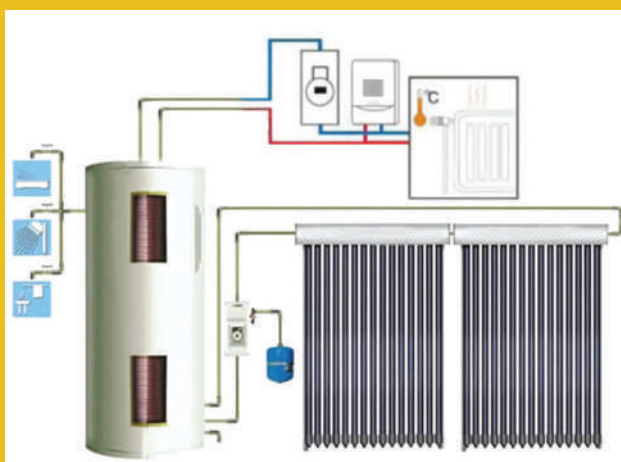
Закрытый активный солнечный водонагреватель высокого давления с двумя теплообменниками (сплит-система)
