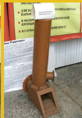
Гидравлический насос (гидротаран)
