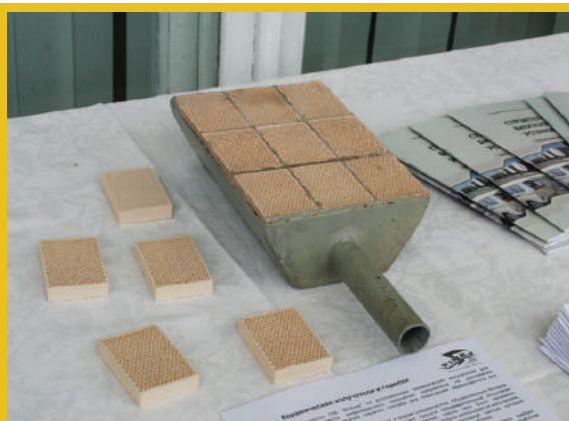
Энергоэффективная газовая горелка на основе инфракрасных керамических излучателей
