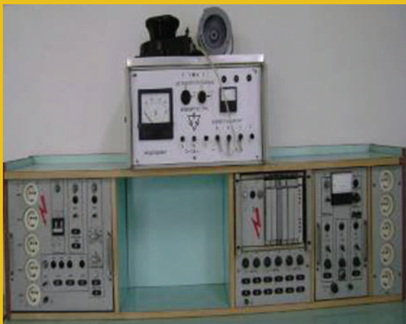
Макет ВЭУ с асинхронным генератором с термопарой ХК. и воздуходувкой, используемой в качестве источника ветровой энергии.
