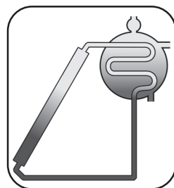
Схема циркуляции холодной и горячей воды в солнечном коллекторе
