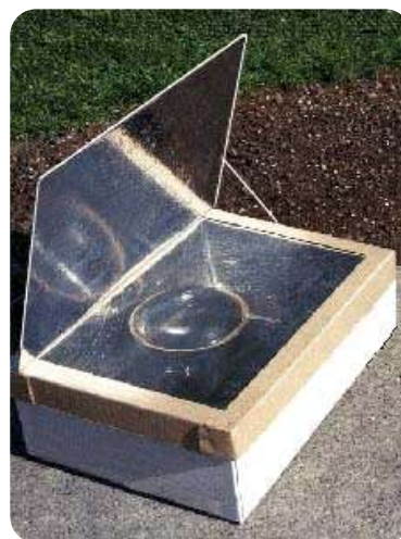
Рис. 15. Коробочная солнечная печь
