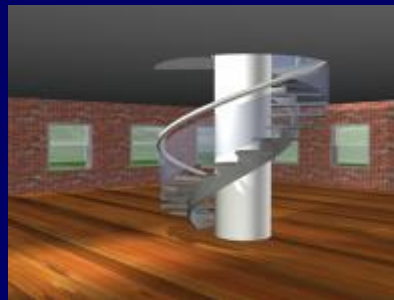
опора – теплообменник внутри дома
