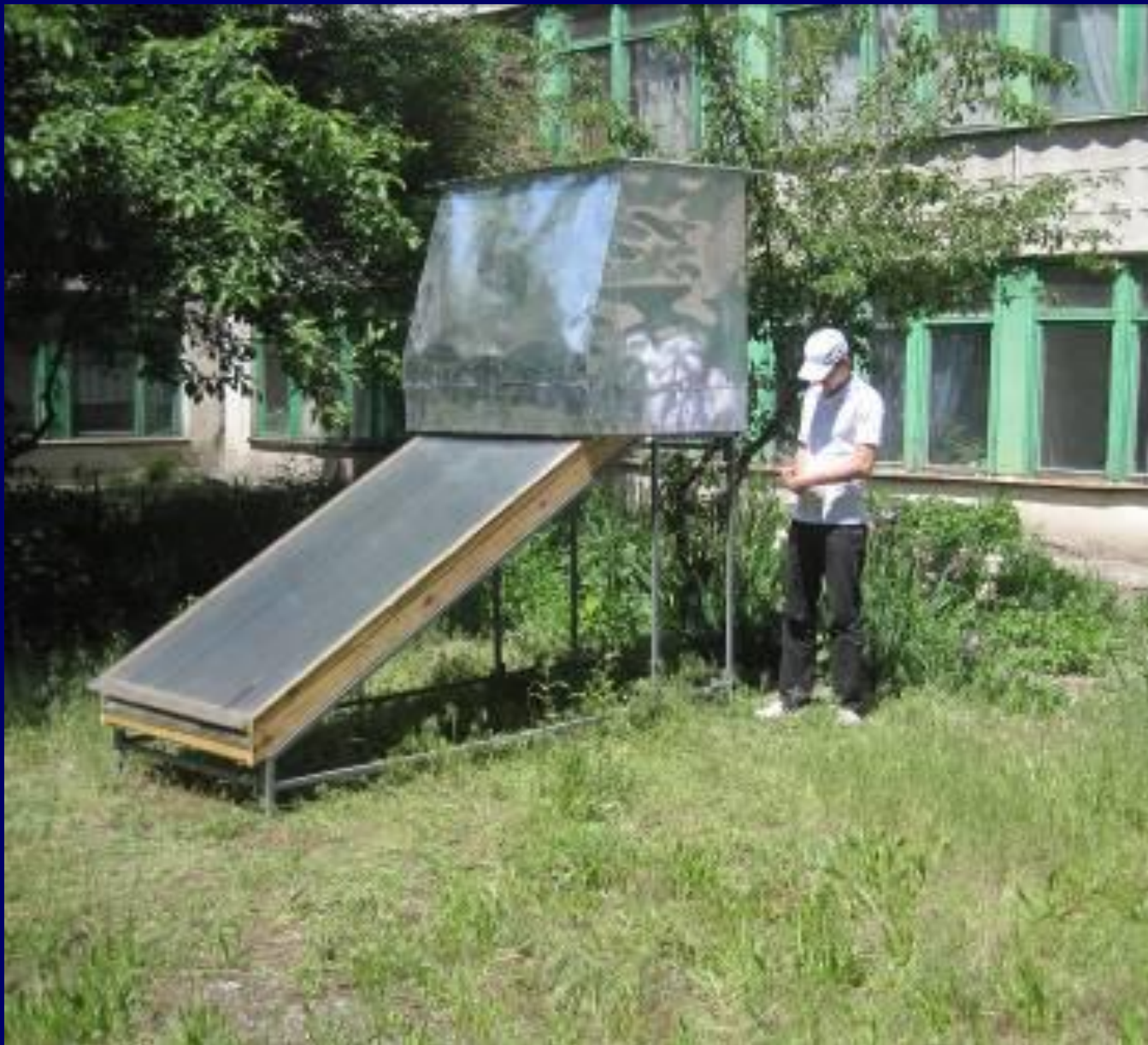
Солнечная сушилка для сушки фруктов. Экспериментальная модель. КНУ им. Ж.Баласагына. Г.Бишкек
