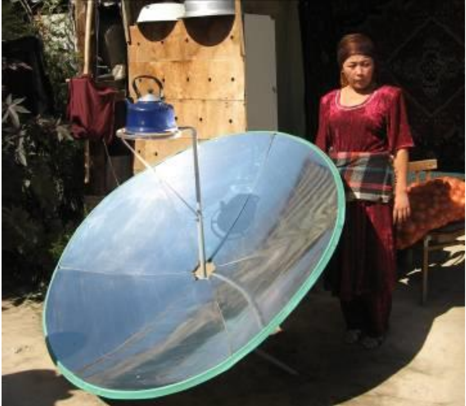
Солнечные печи индивидуального пользования в сельской местности.
