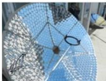
Солнечные печи с зеркалом-концентратором (параболические)
